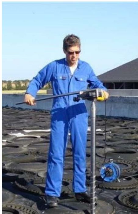
Силосный шнек можно использовать для отбора проб твердого навоза или глубокой подстилки.
